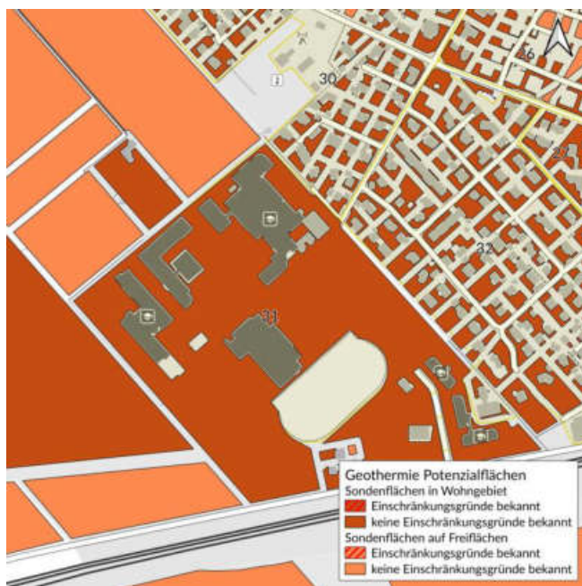
Nutzung von oberflächennaher Geothermie durch Erdwärmesonden
