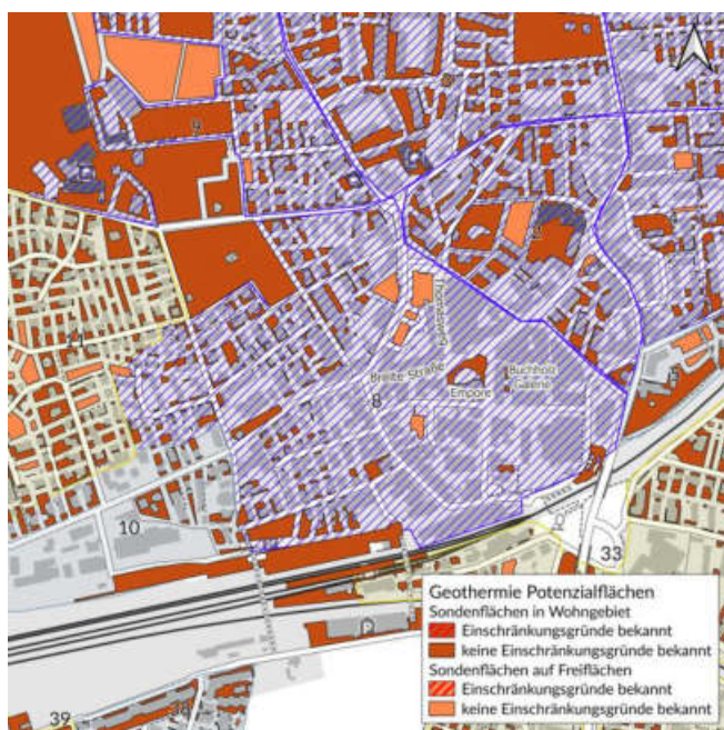
Nutzung von oberflächennaher Geothermie durch Erdwärmesonden
