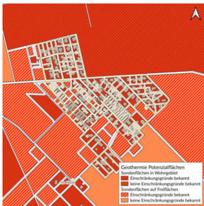
Nutzung von oberflächennaher Geothermie durch Erdwärmesonden
